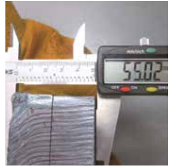
Karbon Çeliği Max. Kesme Kalınlığı: 55 mm
