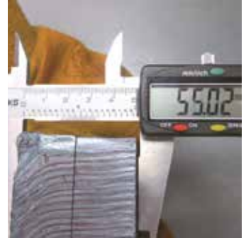
Karbon Çeliği Max. Kesme Kalınlığı: 55 mm
