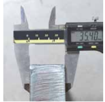
Karbon Çeliği Max. Kesme Kalınlığı: 35 mm
