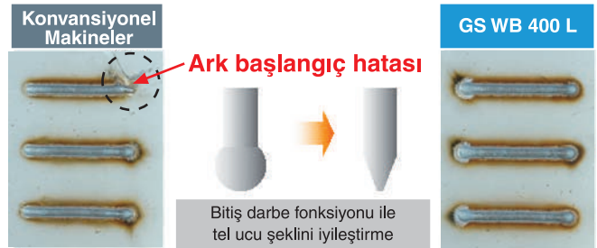
* Ark başlangıç hataları ve başlangıç bölümündeki yetersiz kaynak dikişlerini önlemede ciddi oranda iyileştirme.
