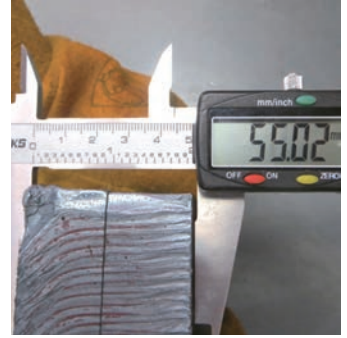
Karbon Çeliği Max. Kesme Kalınlığı: 55 mm
